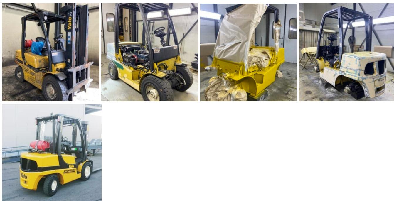
Hierfür werden alle defekten Teile durch neue ausgetauscht und das Gerät wird wieder technisch auf Vordermann gebracht,
