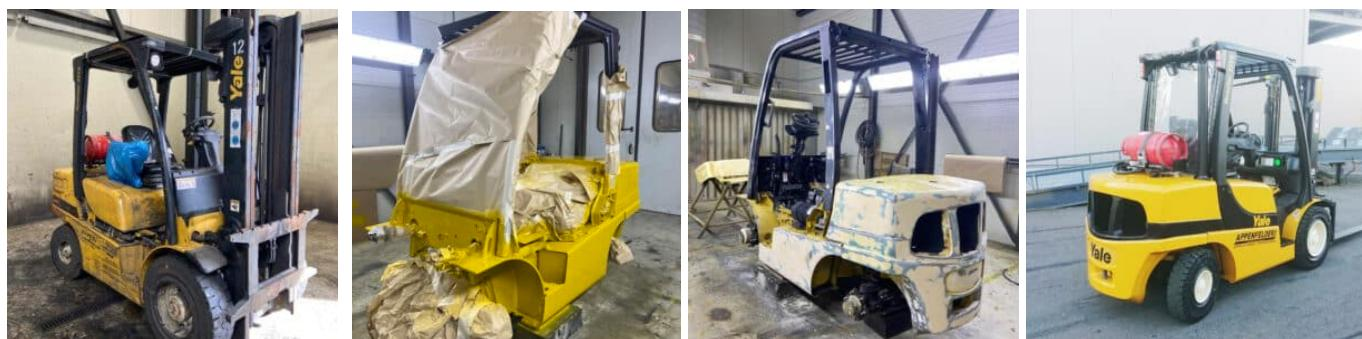
Hierfür werden alle defekten Teile durch neue ausgetauscht und das Gerät wird wieder technisch auf Vordermann gebracht,
